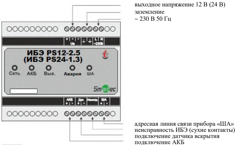
Рис. 3. Расположение контактов ИБЭ исполнений PS12-2.5 и PS24-1.3.
